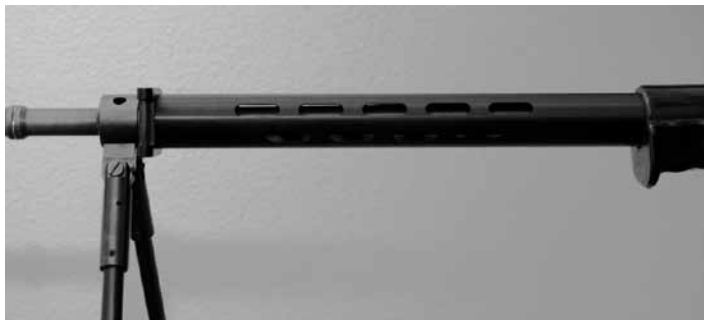
Bild 16: Mantelrohr zu Stgw 57
