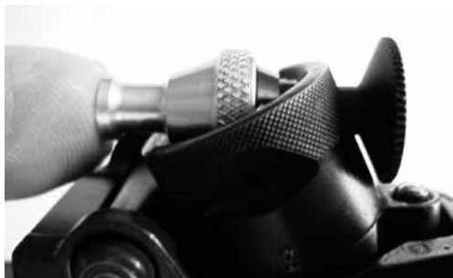
Bild 5: Farbfiltersystem Wyss, aufsteckbar
